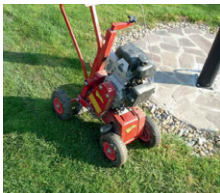
Mit der Aushubmaschine heben wir die Erde aus, so dass Ihre Randleiste mit der Oberkante am Rasen abschließt.
